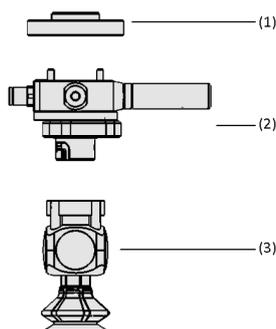
Конструкция системы Захват для робота VEE
